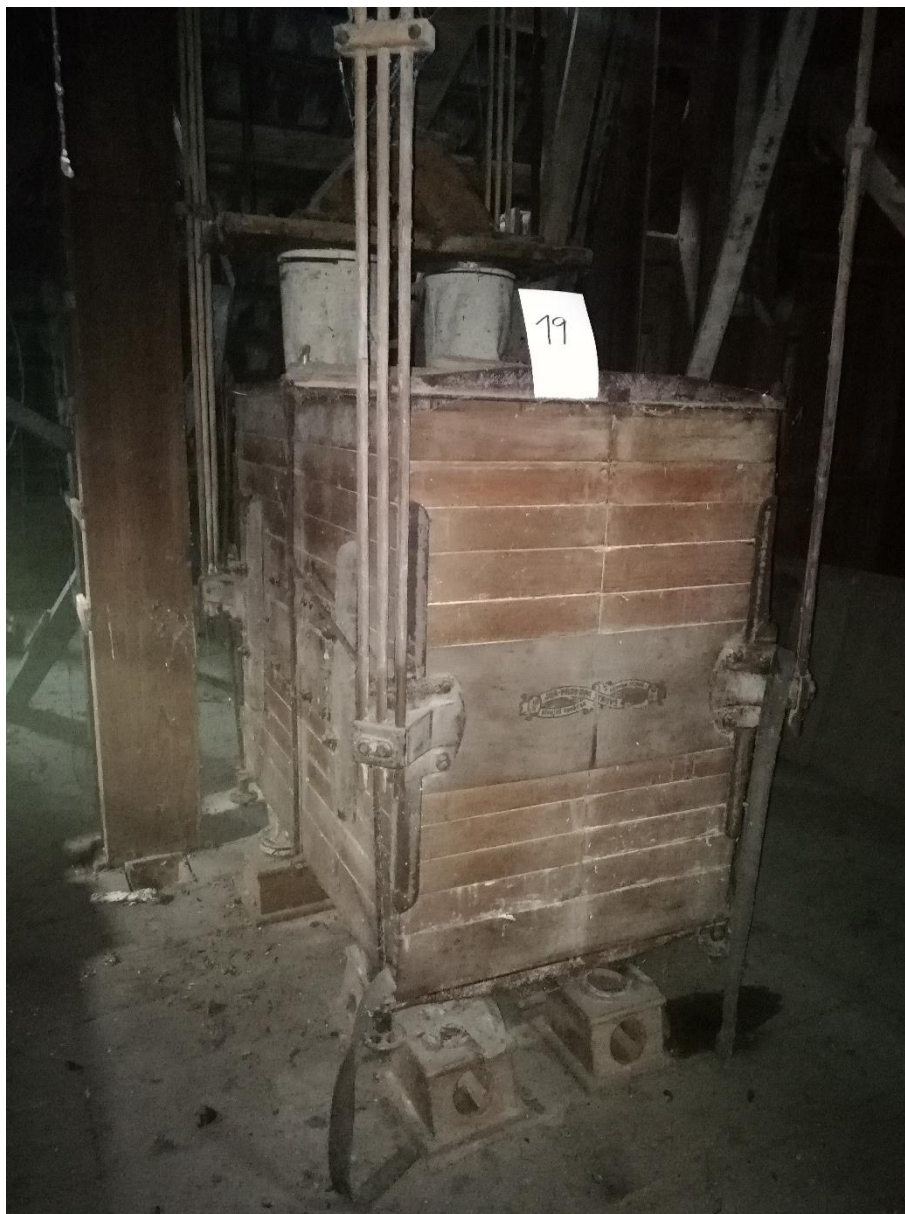
33. 2. NP – rovinný vysievač (PLANSICHTER; č. 19)
