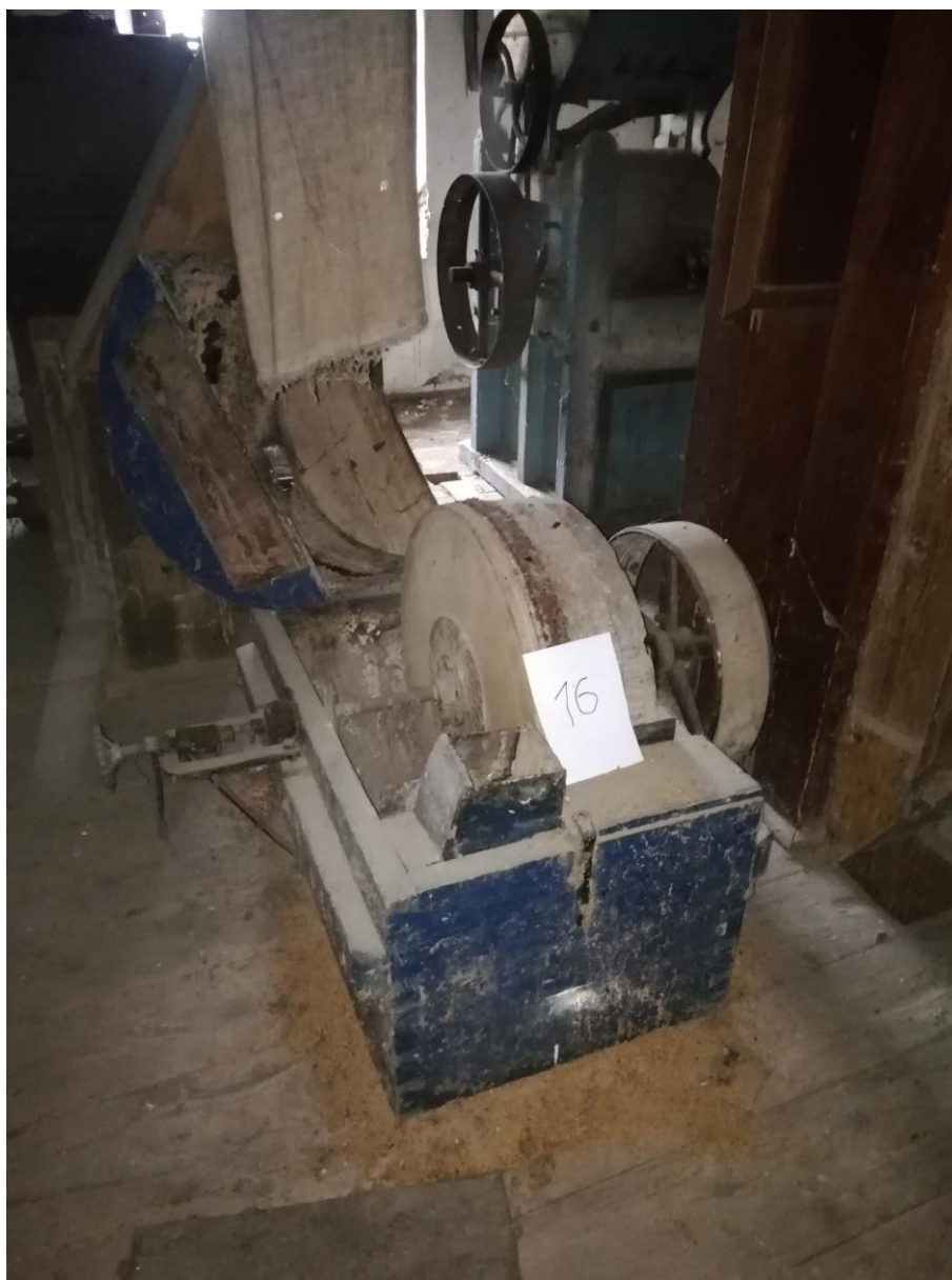
25. 2. NP - lúpačka kamenná (šrotovník) s otvoreným krytom, starší typ - spracovanie prosa (č. 16)
