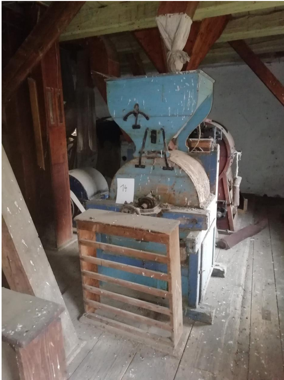
22. 2. NP – kamenný šrotovník- lúpačka na výrobu krúpov (č. 14)
