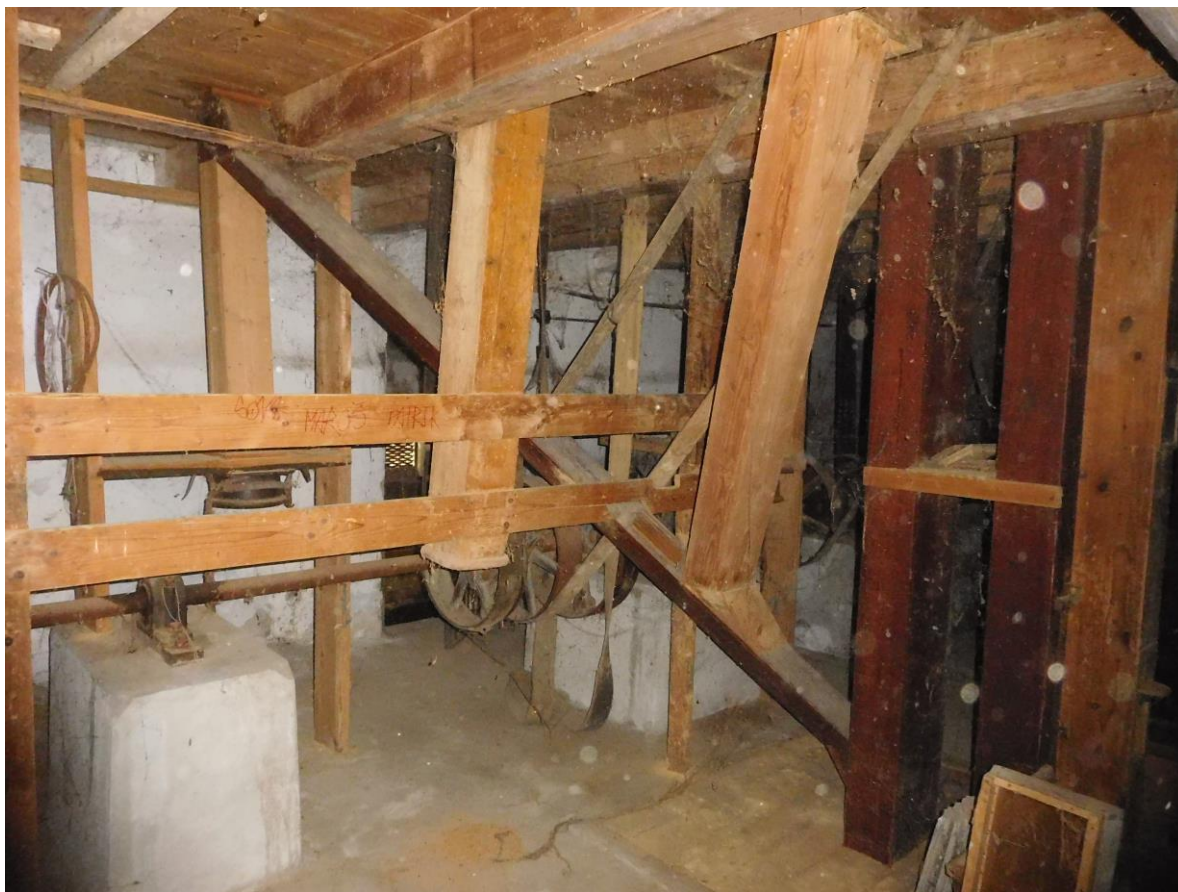
11. 1. NP - spodná transmisia s 10 železnými remenicami
