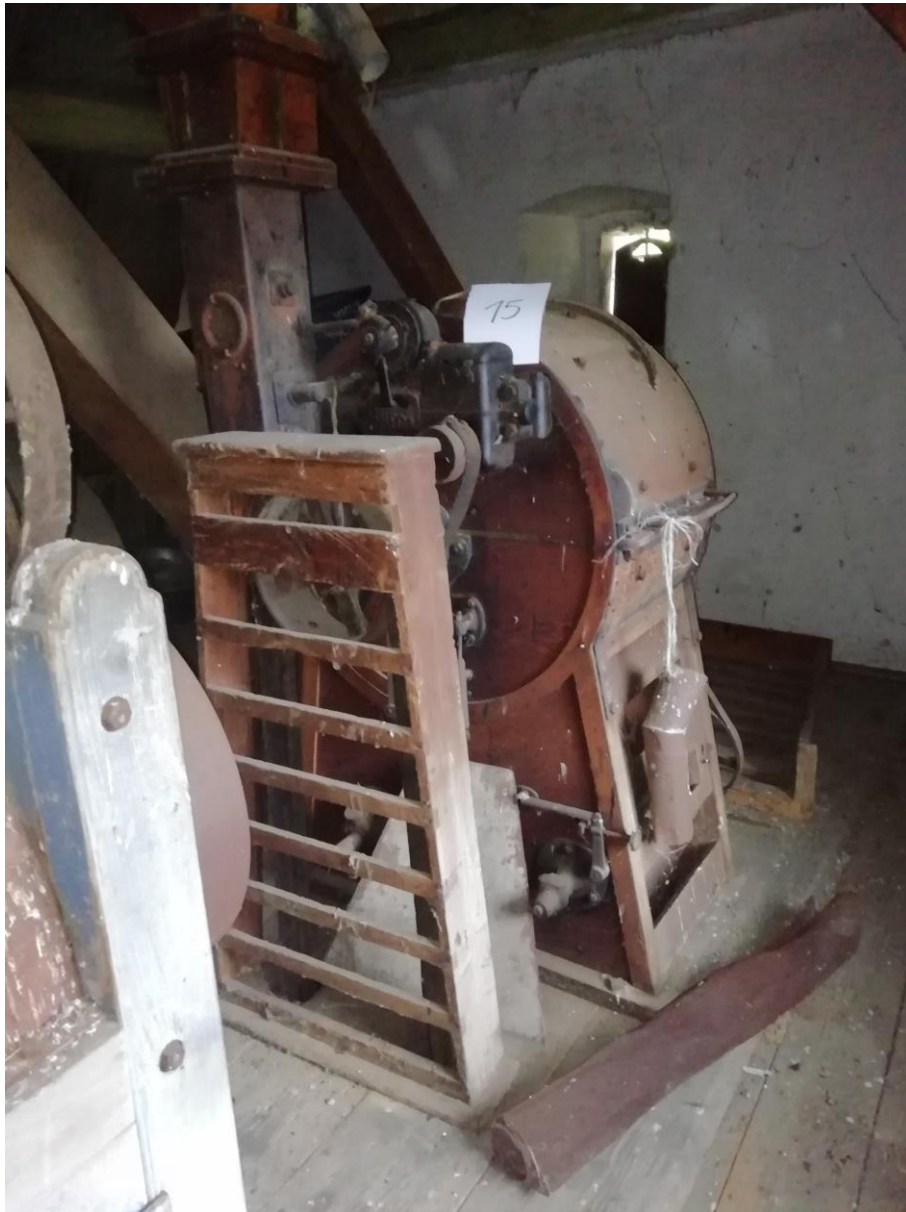
24. 2. NP - lúpačka- šrotovník (č. 15), vzadu južná stena s oknom
